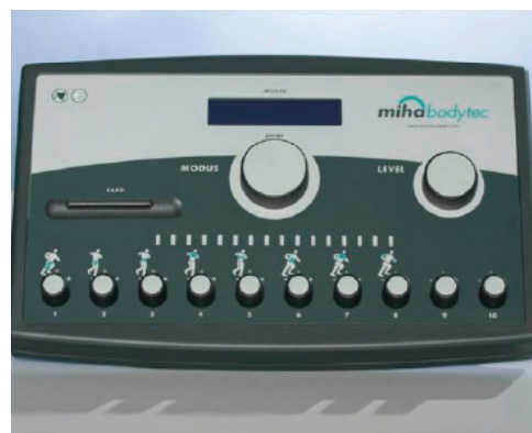
Abbildung 3: WB-EMS-Bediengerät mit Intensitätsreglern für unterschiedliche Körperregionen.
